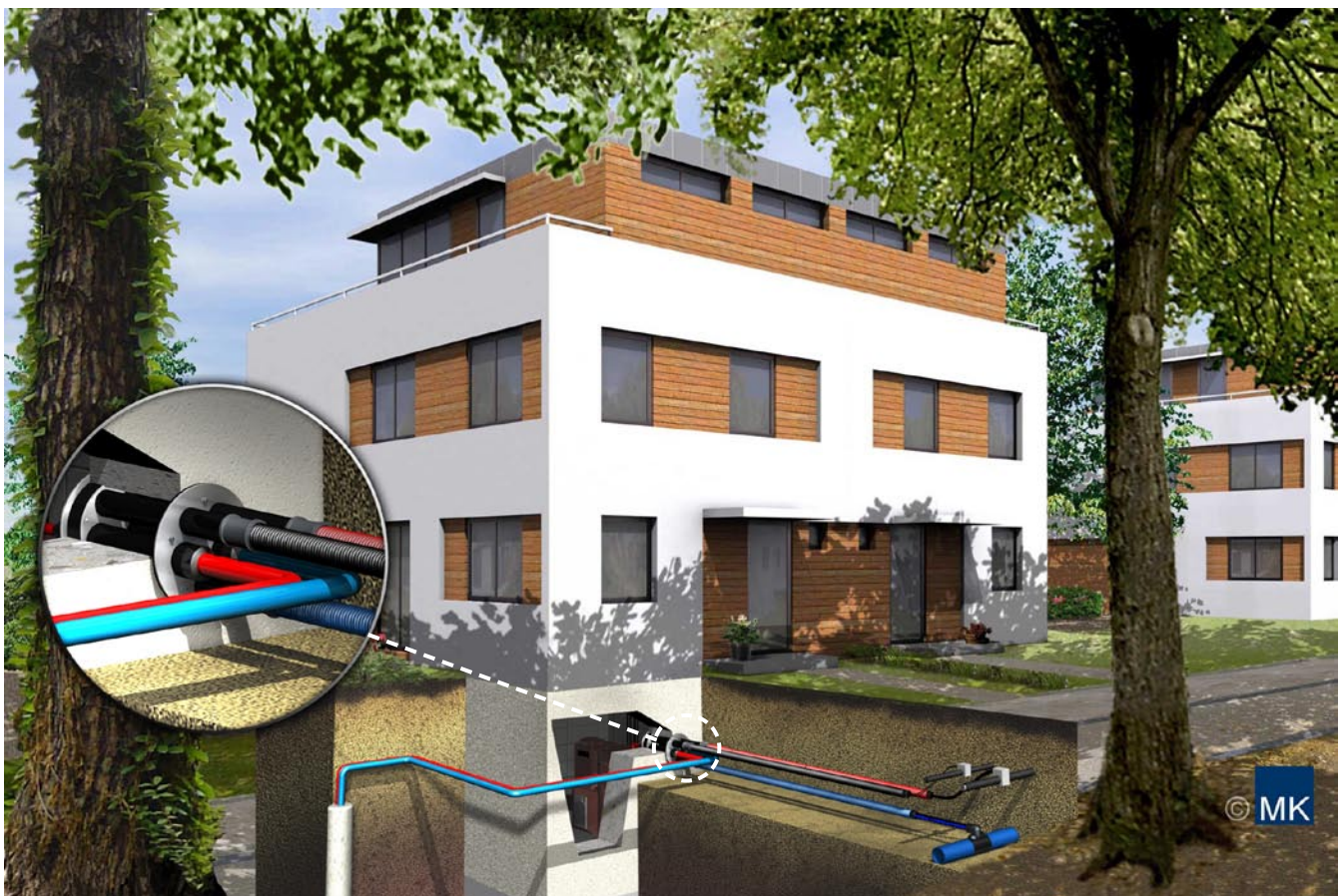
Schematische Darstellung eines Hauses mit Erdwärmesonde. Quelle: mk Gesellschaften von Architekten. www.mk-architekten.com
