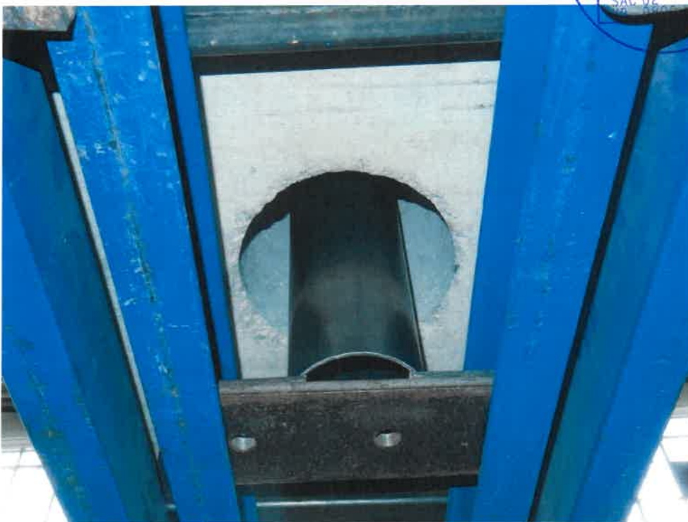
Bild 14: trockene Unterseite des Prüfkörpers
