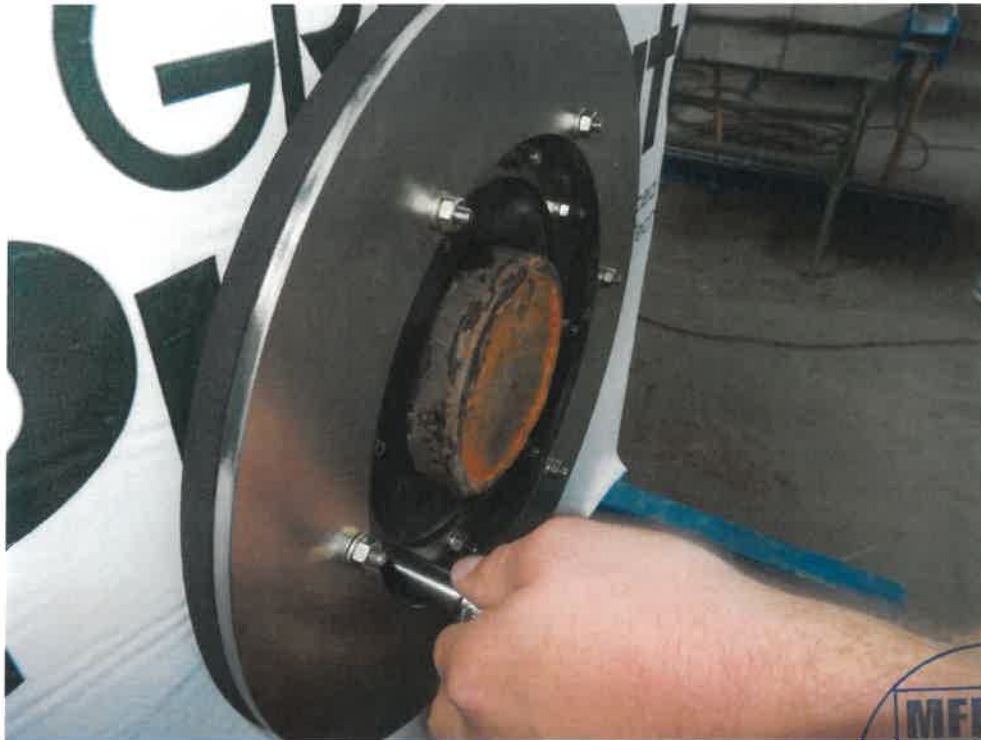
Bild 11: Anziehen der Muttern des inneren Flansches
