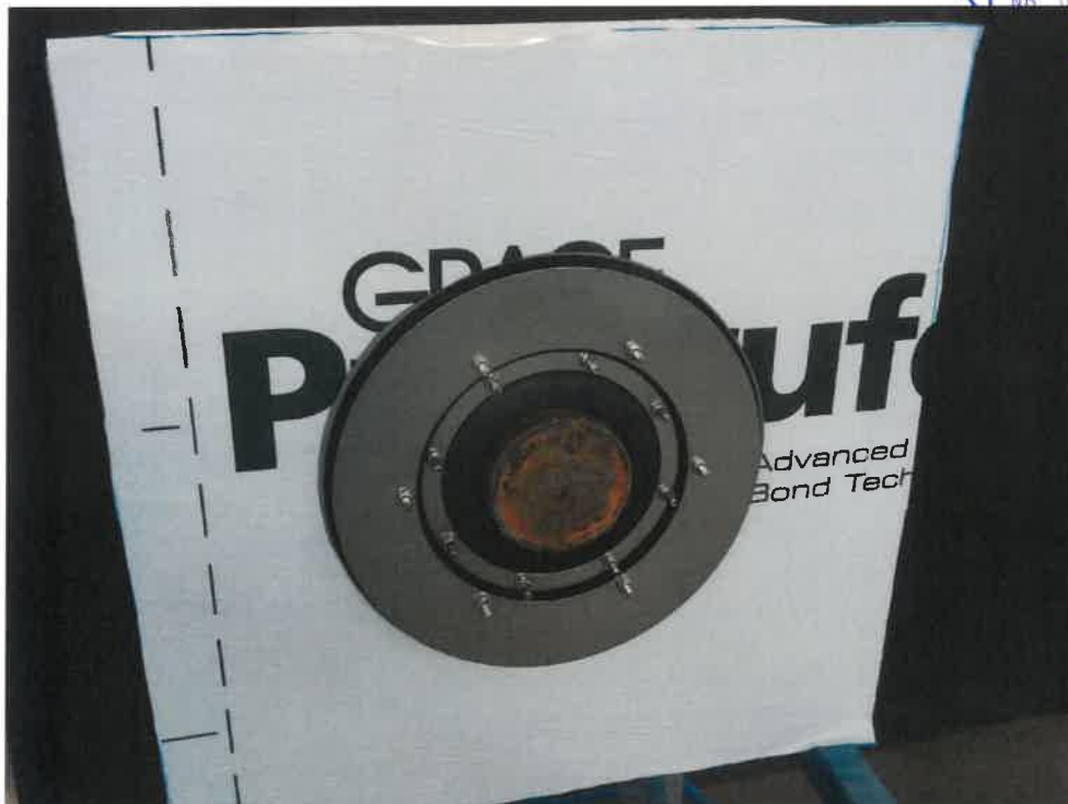
Bild 12: Prüfkörper mit Dichtungseinsatzes Curaflex SD DN 200 , heraus gequollenem Curaflex Butyl-Dichtungsband Type 1753 und druckwasserdicht verschweißstem Rohrstutzen
