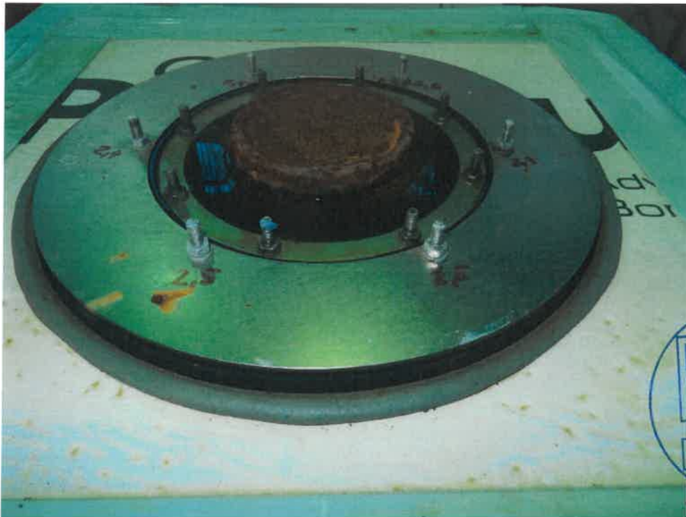
Bild 17: Dichtungseinsatz Curaflex SD DN 200 in Verbindung mit der FBVB Preprufe® 800PA nach der Druckwasserprüfung
