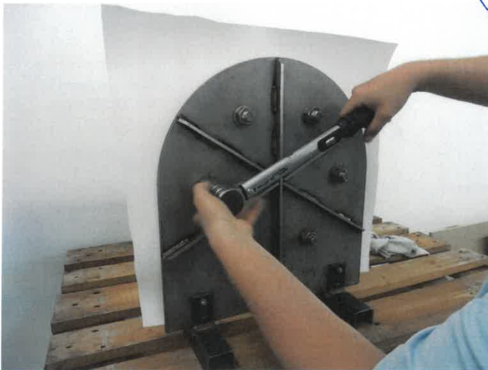
Bild 6: Zusammensetzen der Los- und Festflanschkonstruktion und Kontrolle der Drehmomente
