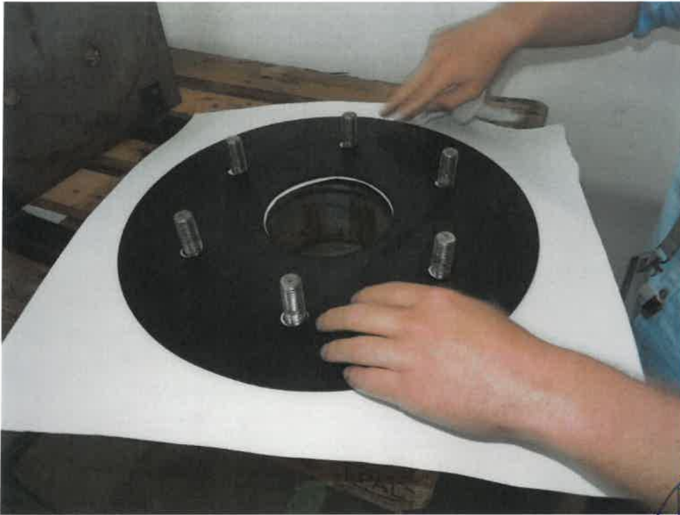
Bild 5: Auflegen der 2. EPDM-Zulage auf die FBVB Preprufe® 160R
