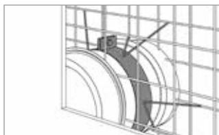
Bsp.: Befestigung in Stahlschalungen durch Schweißverbindungen mit Rohrschelle (Rohrschelle bauseits).
