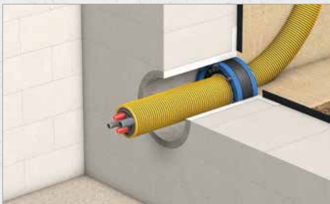
Systematische Darstellung: Einbau Curaflex Nova® Senso in Futterrohr Curaflex® 3001
