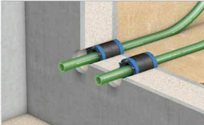
Systematische Darstellung: Einbau Curaflex Nova® Uno/breit
