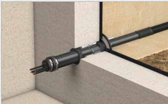
Systematische Darstellung: Einbau Quadro-Sicura® Quick/X
