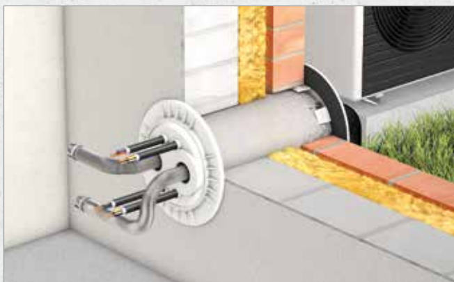
Systematische Darstellung: Einbau DOYMAfix® Connect HP/O
