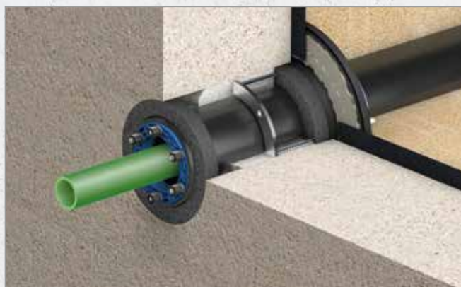
Systematische Darstellung: Einbau Quadro-Sicura® Quick/H in Kombination mit Dichtungseinsatz Curaflex Nova® Multi
