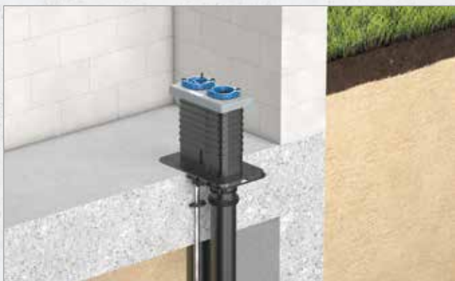
Systematische Darstellung: Einbau Quadro-Sicura® Nova R2
