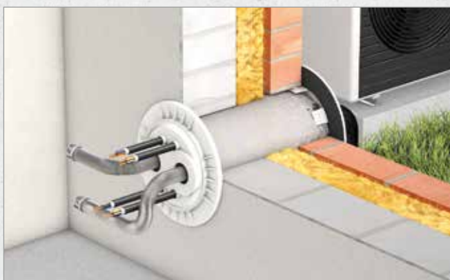
Systematische Darstellung: Einbau DOYMAfix® HP/O
