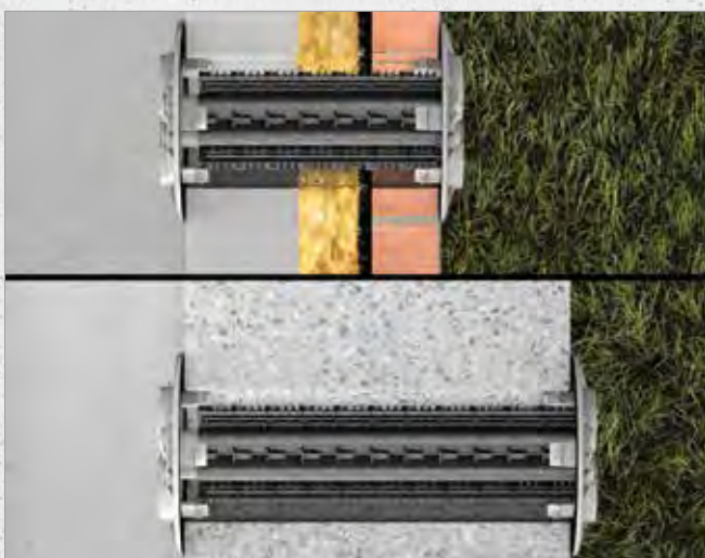
Systematische Darstellung: Einbau DOYMAfix® HP/O
