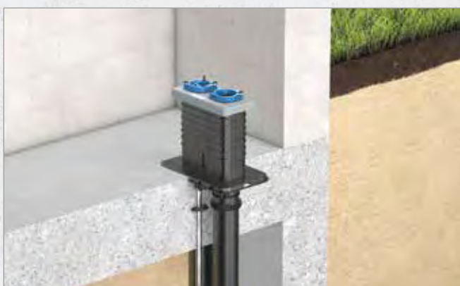
Systematische Darstellung: Einbau Quadro-Sicura® Nova R2
