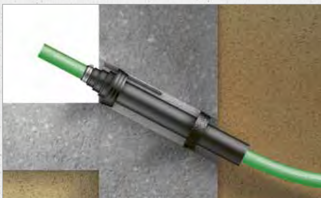
Systematische Darstellung: Schrägdurchführung Quadro-Sicura® SD
