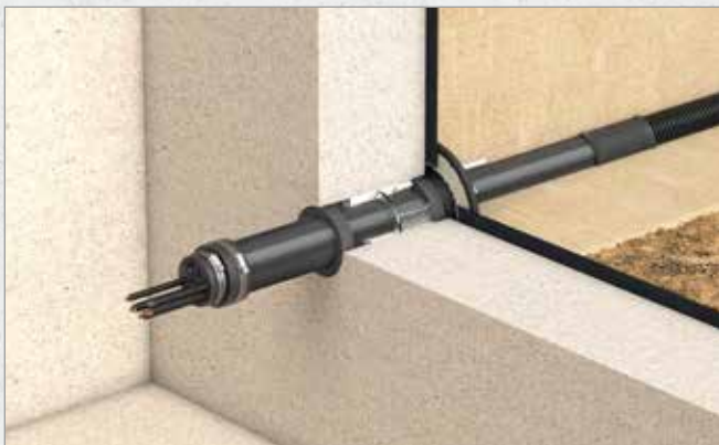
Systematische Darstellung: Einbau Quadro-Sicura® Quick/X
