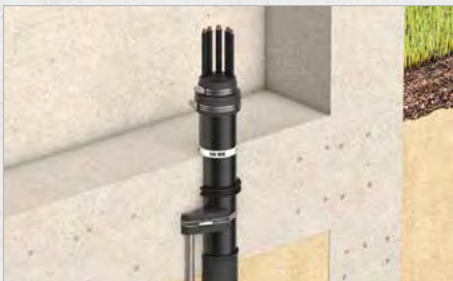
Systematische Darstellung: Einbau Quadro-Secura® O.Con 1
