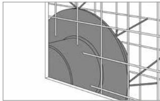
Bsp.: Befestigung in Stahlschalungen durch Schweißverbindungen (bauseits).
