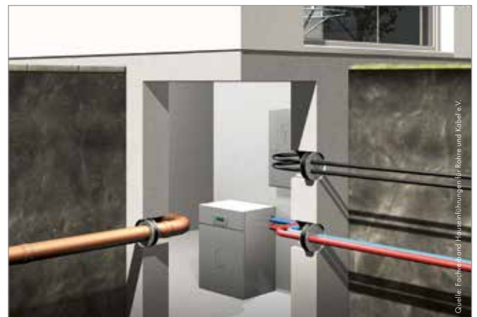
Bauwerksdurchdringungen für Ver- und Entsorgungsleitungen
