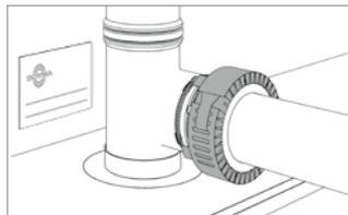
Brandschutzschild ausfüllen und so anbringen, dass es beim Entfernen der Einhausung sichtbar wird.
