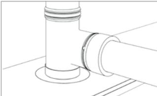
Gussrohrabzweig mit Übergang auf Kunststoffrohr mit Konfix-Verbinder.
