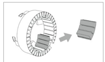
Um die Manschette Curafam® Konfix<sup>Pro</sup> DN 100 auf den Rohrverbindern DN 70, DN 75 und DN 80 zu verwenden, vor der Montage 3 Brandschutz-Formteile herausbrechen.\*
